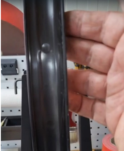
Bild 7: Felgenband nach Reifenplatzer
